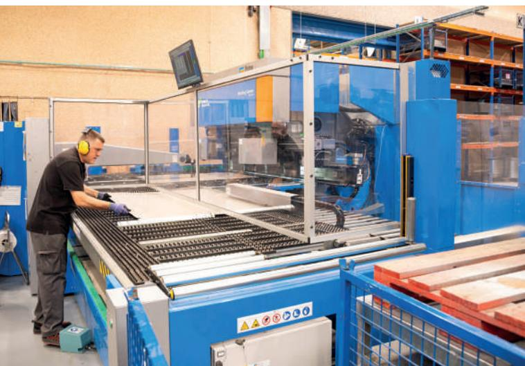
La nueva paneladora en funcionamiento. |
